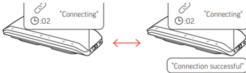
Verbindung mit Endgerät (Bluetooth oder Kabel) herstellen → Button zum Verbinden (siehe Bild) gleichzeitig auf beiden Geräten für ca. 2 Sekunden drücken → Sobald „Connection successful“ sind beide Geräte verbunden
